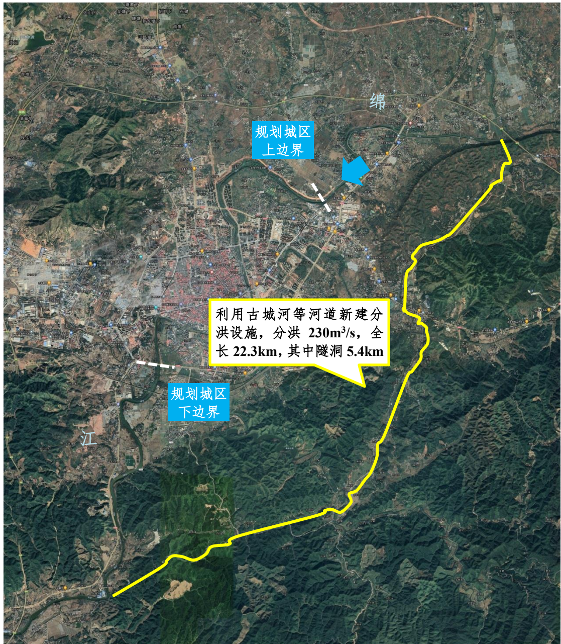
图 6.6-8 瑞金市区新建分洪设施方案示意图
